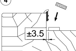
Positionner des cales SILICARTON (ép.5mm) qui permettront de supporter et maintenir en place les vitrages sur la traverse basse du cadre (à 100mm des bords)
