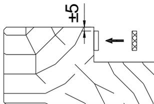
*Pour la pose avec finition silicone, le joint est remplacé un joint FLAMISEAL (blanc) positionné 5mm plus bas que la contre-feuillure.*
