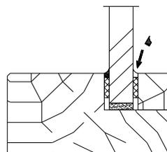
*Dans le cas d'une pose avec finition silicone, réaliser également un joint mastic entre le cadre et la parclose et le vitrage.
