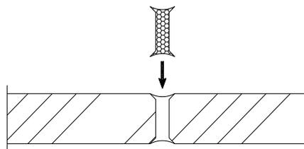
Réaliser le calfeutrement entre les vitrages à bord polis avec un joint mastic silicone FIRESTOP 791T recouvrant la totalité du chant présent.
