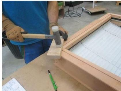
Fixer les parcloles dans le cadre en pinçant le vitrage à l'aide de vis bois  $\varnothing 4 \times 50$  à 100mm des bords du cadre et au pas de 250mm maxi sur la longueur et la hauteur (Parcloles pré-perçées).
