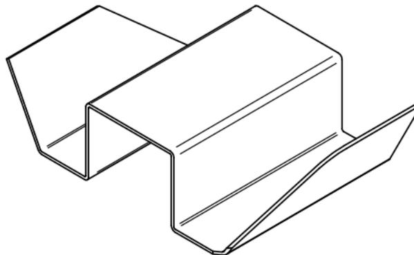
6 Omégas prévus initialement sur huisserie avec trous de fixations ou pattes à scellement
