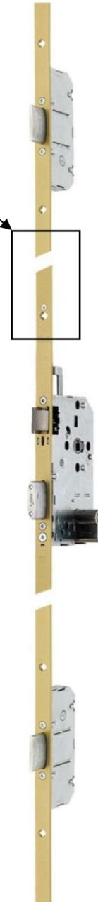
La condamnation à 2 tours de la serrure n'est rendue possible qu'après l'installation de la vis de barillet F dans son cylindre ET le démontage de l'insert A situé sous le pêne ½ tour.
