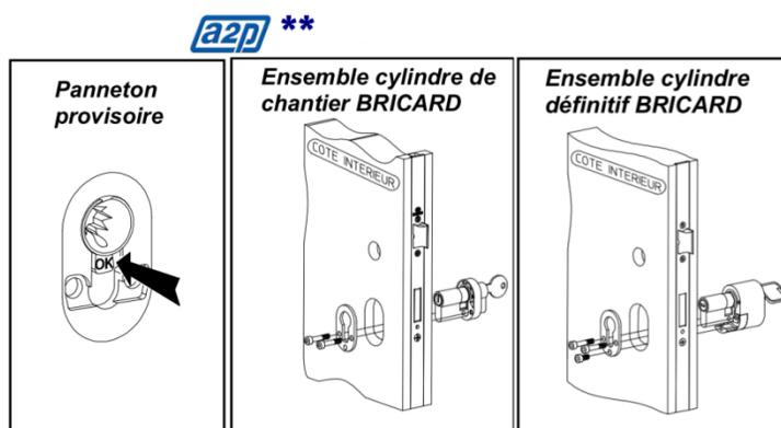
■ La manœuvre du mécanisme de la serrure doit se faire **EXCLUSIVEMENT** au moyen du panneton provisoire, du cylindre provisoire ou du cylindre définitif prévu à cet effet.
