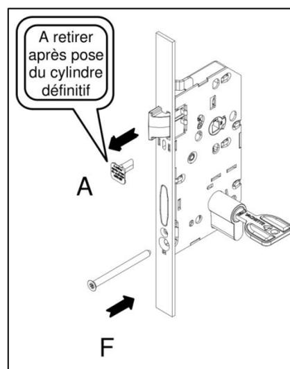
La condamnation à 2 tours de la serrure n'est rendue possible qu'après l'installation de la vis de barillet **F** dans son cylindre **ET** le démontage de l'insert **A** situé sous le pêne ½ tour.
