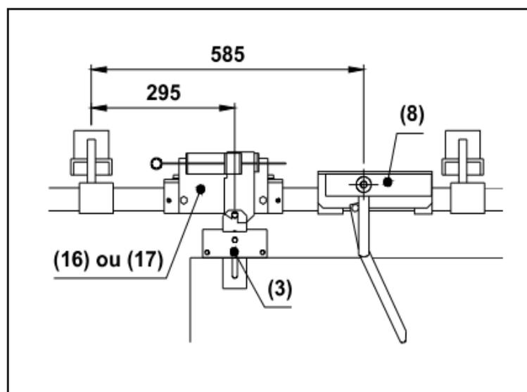
**Equipements associés :** Verrouillage électromagnétique ou mécanique sur rail
