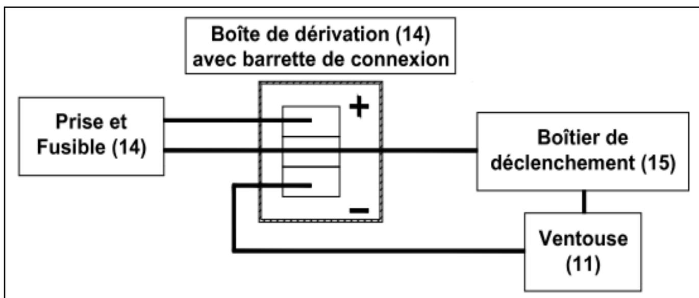
Principe du branchement électrique
