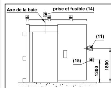
**Equipements associés :** Ligne fusible thermoélectrique + Bouton poussoir de fermeture
