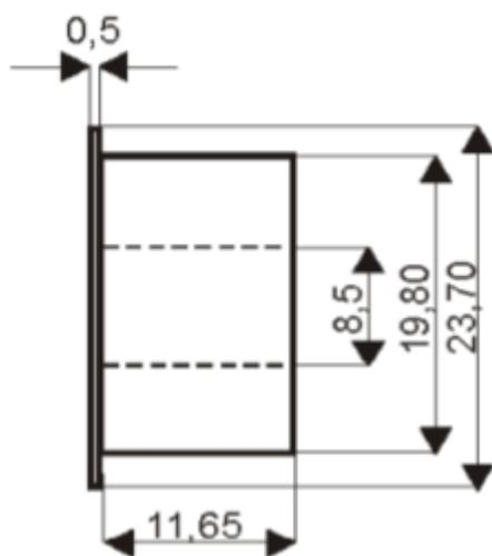
Bride de montage en métal positionnée au niveau du boîtier de contact et d'aimant (Si nécessaire)
