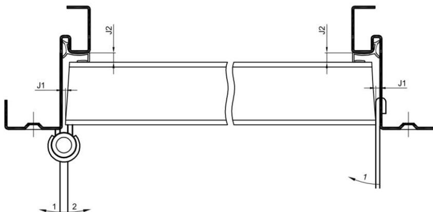
Régler les jeux latéraux J1 en agissant alternativement et en directions opposées sur le noeud des paumelles mâles et sur le noeud des paumelles femelles, de façon à ne pas modifier le jeu J2 côté paumelles (compression du joint).
