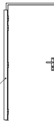
Régler, si nécessaire, la compression du joint côté serrure (jeu J2) en agissant sur la languette de la gâche au niveau du pêne 1/2 tour.
