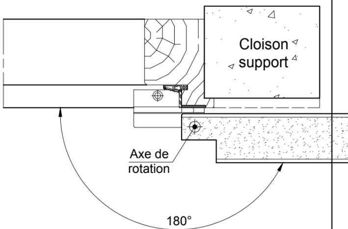
Ouverture pour un ouvrant affleurant à la cloison
