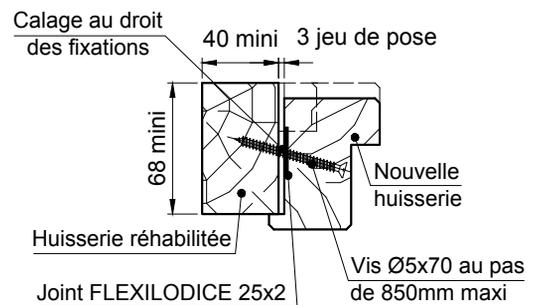
Mise en oeuvre des profils de fixation en fonction de la cloison support (voir pages suivantes)
