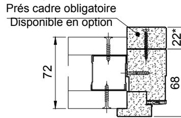
\* ép. 22mm pour cloison 72x36 et contre cloison
