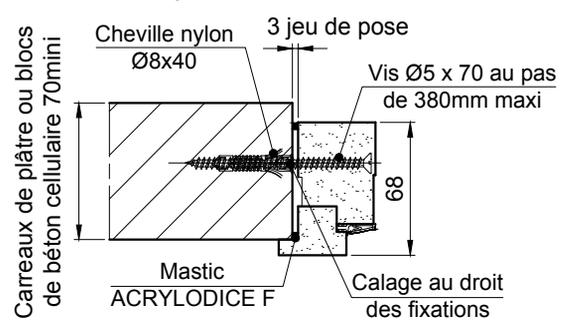
Cloison flexible en plaques de plâtres 72x36, 98x48, 98x62 et contre cloison
