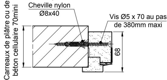
Cloison flexible en plaques de plâtres 72x36, 98x48, 98x62 et contre cloison
