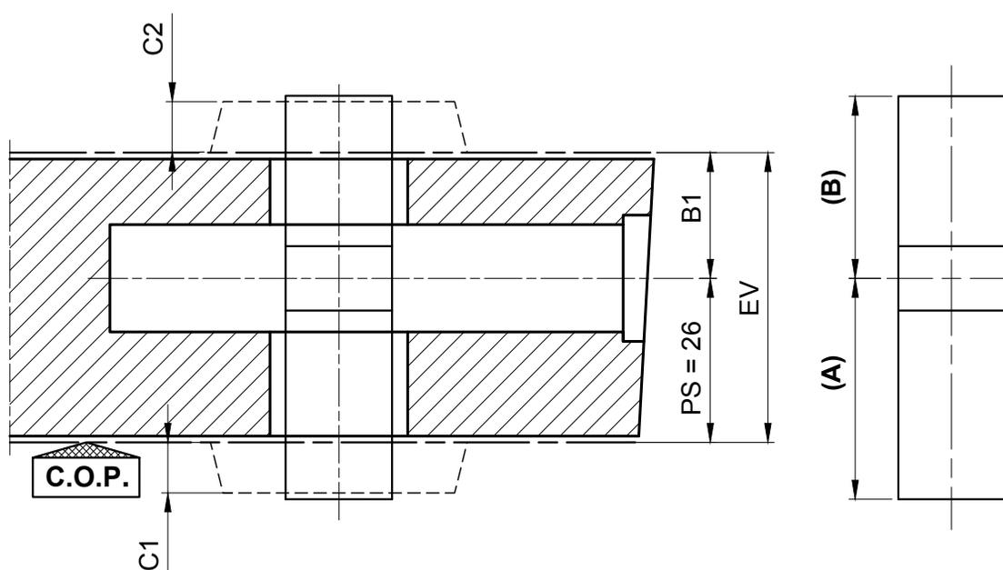
**EV** : Epaisseur suivant finition (46mm en Prépeint et Placage / 48mm en Stratifié)
