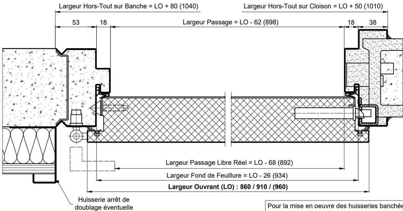
Pour la mise en oeuvre des huisseries banchées, il est conseillé d'utiliser le mannequin de pose métallique MALERBA
