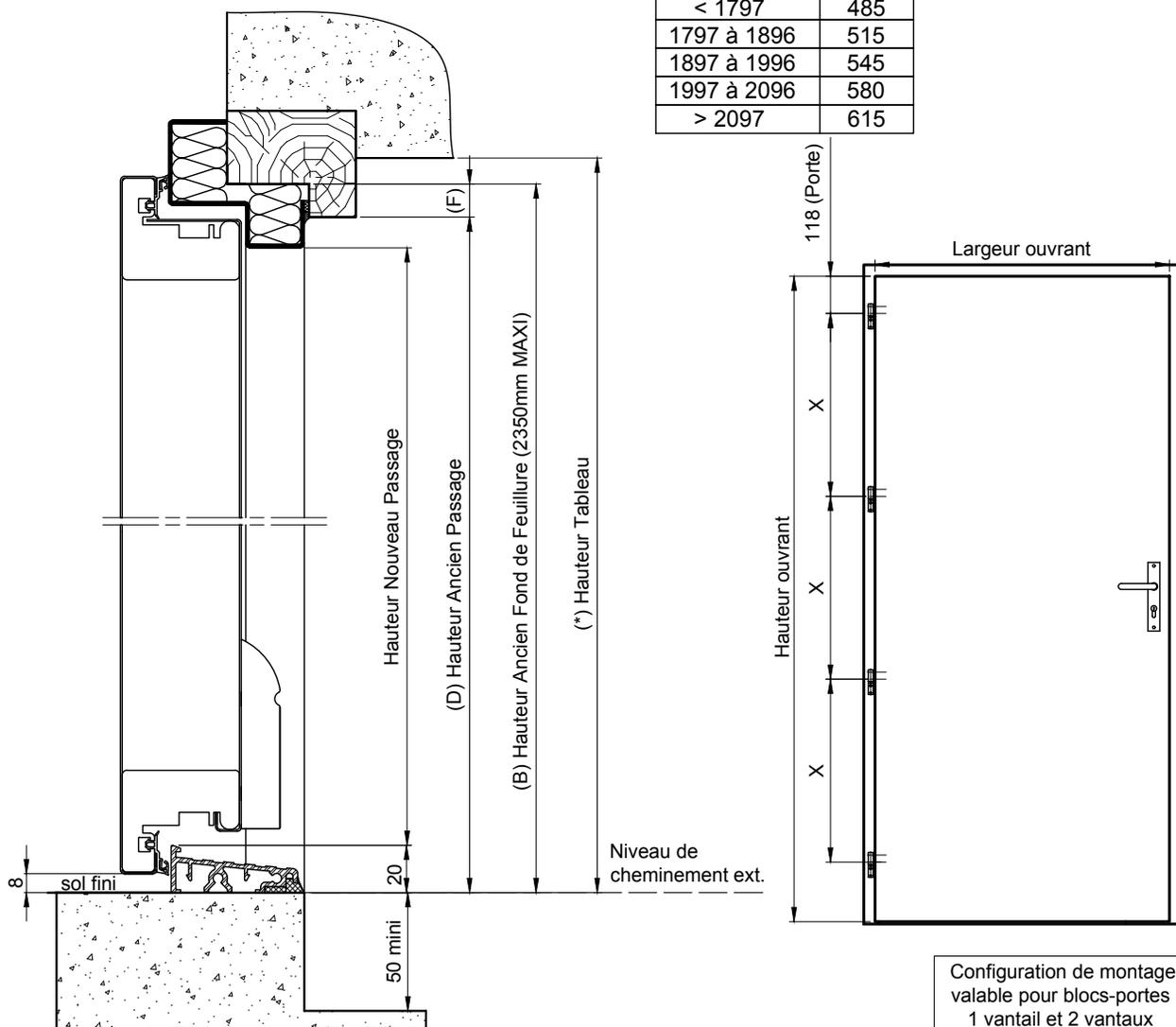
Configuration de montage valable pour blocs-portes 1 vantail et 2 vantaux
