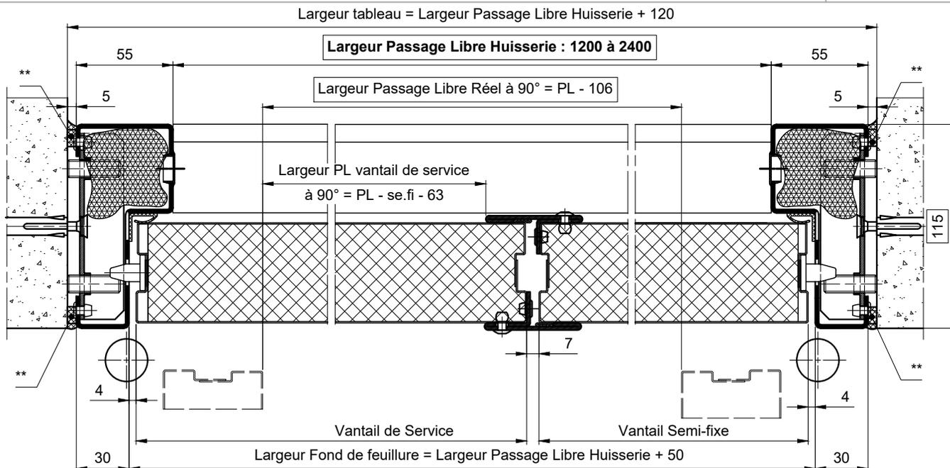
\*\* : Mastic d'étanchéité sur fond de joint
