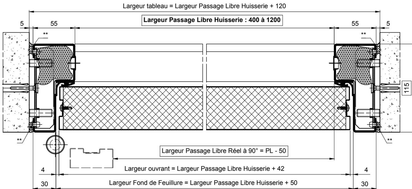
\*\* : Mastic d'étanchéité sur fond de joint
