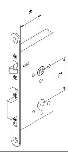
\* PMIS : Serrure électrique axe à 55 mm PMT : Serrure électrique axe à 65 mm
