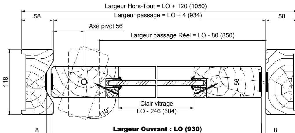
**Attention :** Angle d'ouverture maxi  $110^\circ$  pour une section maxi de  $118 \times 58$  avec perte de passage libre réel
