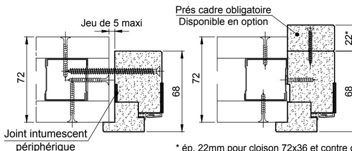
\* ép. 22mm pour cloison 72x36 et contre cloison
