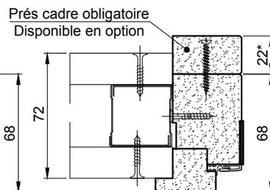
\* ép. 22mm pour cloison 72x36 et contre cloison
